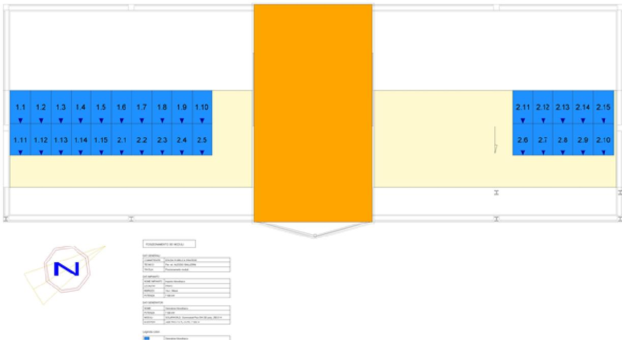
Fig. 4: Posizionamento dei moduli del generatore Generatore fotovoltaico
